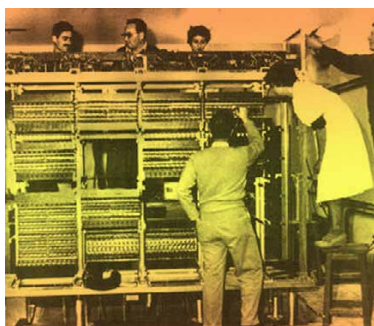
רוב הרכיבים הובאו מחו"ל, אבל קצתם יוצרו במפעל מקומי לחלקי אופניים. הרכבת המחשב | מקור: ויקיפדיה, itzikowitz.20m.com
